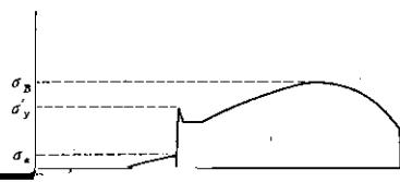
加工用冷間圧延高張力鋼板（板厚0.8mm）の引張強さと成形性との関係を Fig. 11, 12 に示す。
